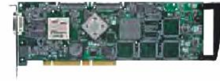
VPX-IN/VID8采集卡 8通道S-Video/复合信号采集
